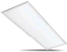
THOR LED 30x120 ON/OFF 220 + 240 Vac / 40W / UGR<19 / CRI≥80 / SDCM 3 / Ta -20°...+40°
