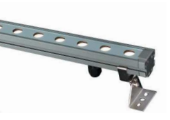
BAR LED 100cm 35° 24 Vdc / 48W / CRI≥80 / SDCM 3 / Ta -15°...+45°
