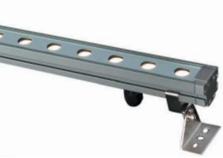
BAR LED 50cm 35° 24 Vdc / 24W / CRI≥80 / SDCM 3 / Ta -15°...+45°
